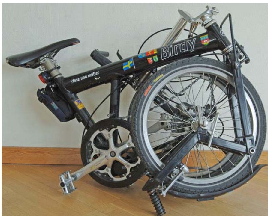
Black Birdy som bagage – liten, hanterlig, transporterbar (längd 90 cm. höjd 65 cm, bredd 40 cm).
